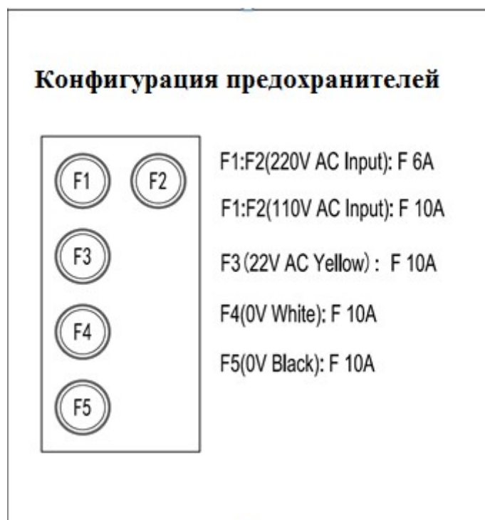
Рис. 5. Блок предохранителей напольного блока подключения
