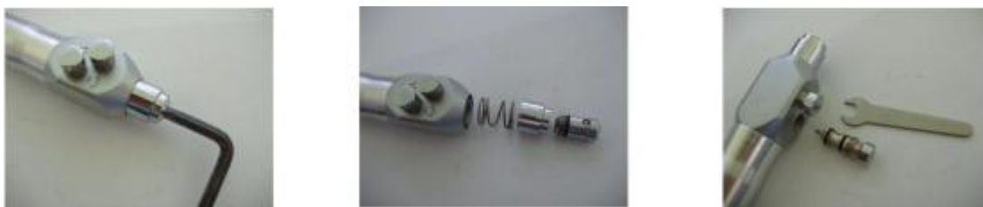
Рис. 27. Разбор прямого пистолета для очистки
