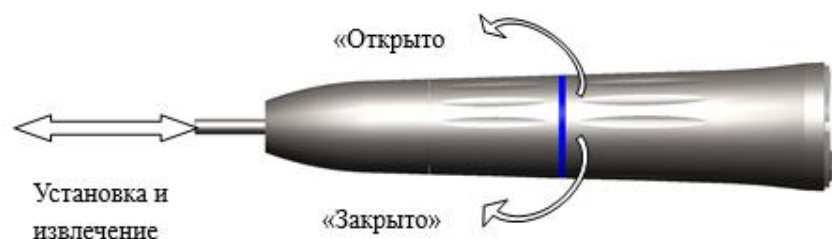
Рисунок 34 – Установка и снятие бора в прямом наконечнике
