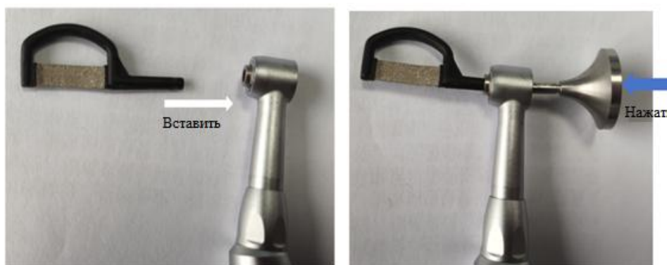
Рисунок 43 – Установка и снятие пил в наконечнике
