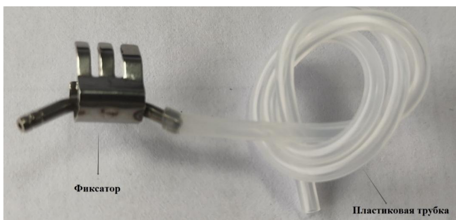
Рисунок 21 – Система внешнего охлаждения (пластиковая трубка и фиксатор)
