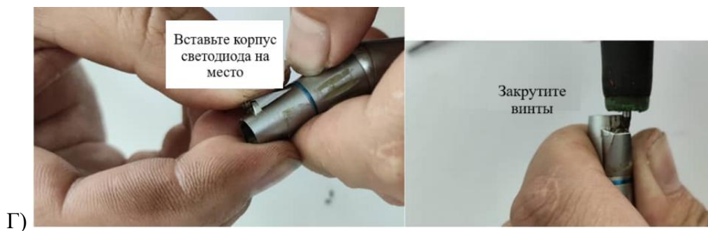
Рисунок 40 – Замена светодиодной лампочки
