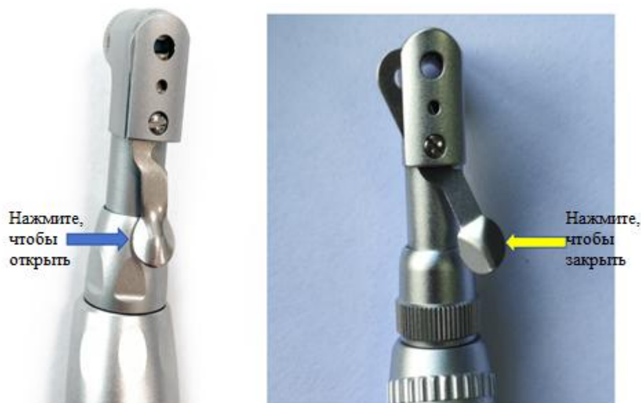
Рисунок 32 – Установка и снятие бора в наконечнике с цанговым зажимом
