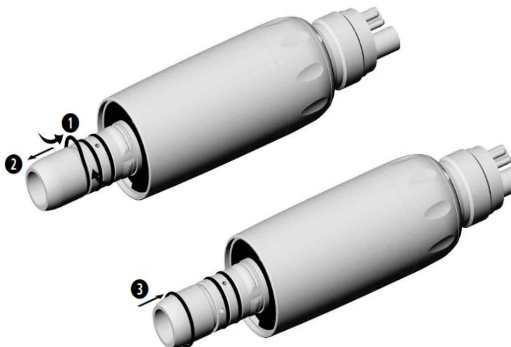
Рисунок 39 – Замена уплотнительных колец
