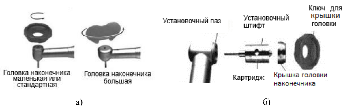
Рисунок 38 – Замена картриджа: а) снятие; б) установка.
