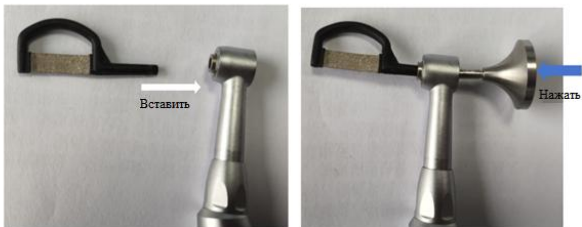
Рисунок 33 – Установка и снятие бора в наконечнике, межзубном понижающем (IPR)
