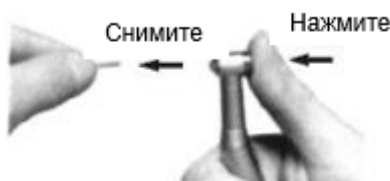
Рисунок 31 – Установка и снятие бора в наконечнике с кнопочным зажимом
