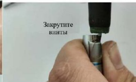
Рисунок 52 – Замена светодиодной лампочки
