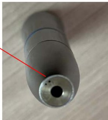
Рисунок 32 – Отверстия для подачи воды и воздуха, для прочистки которых используется игла
