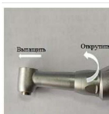
Рисунок 50 – Замена головки углового наконечника с внешним охлаждением
