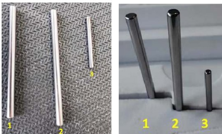
Рисунок 34 – Тест-бор: 1 – только для модели SEN-10C; 2 – для прямых наконечников; 3 – для угловых наконечников (вариант с диаметром Ф1.60 мм)
