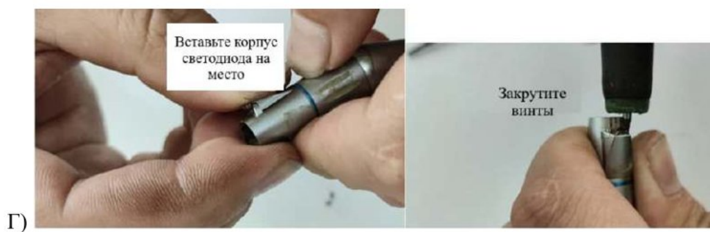
Рисунок 52 – Замена светодиодной лампочки
