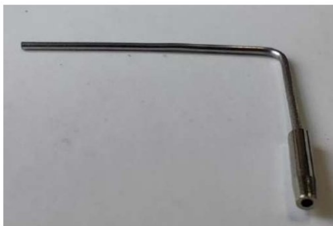
Рисунок 40 – Система внутреннего охлаждения (металлическая трубка)
